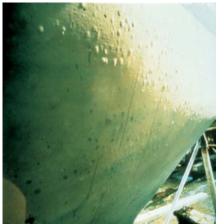
Ampollas. Normalmente sólo se observan en la obra viva y suelen adoptar la forma de burbujas en el antifouling . En este caso, será preciso retirar el antifouling para determinar con exactitud la causa del problema.
