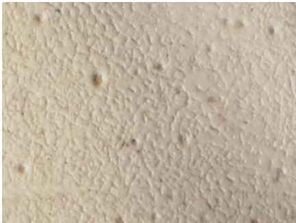
Superficie de GRP observada con una lente de 32 aumentos. Presenta “cabezas de alfiler” en la superficie pigmentada.
