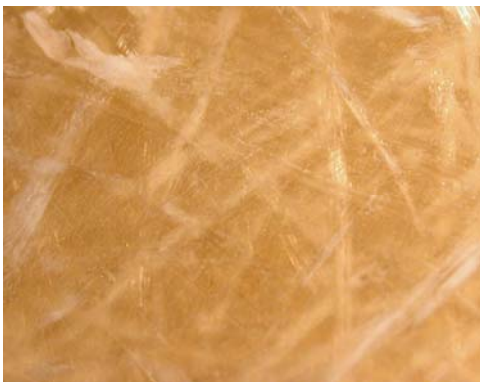
Superficie de fibra GRP mostrando Fibras prominentes, con aumento de 32x
