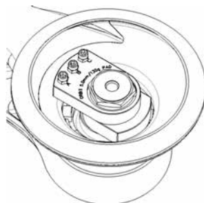
2. Maskinkonfiguration för användning med pad saver/slipplatta.
