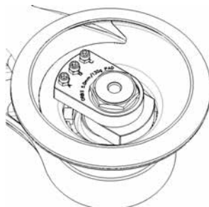
2. Configuração da máquina para o uso com protetor de suporte ou interface.
