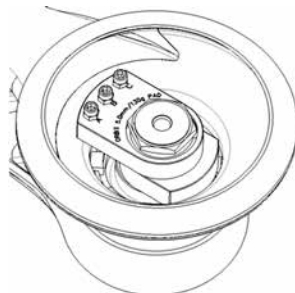
2. Suojalaipan tai välilaipan kanssa käytettäväksi tarkoitettu rakenne.
