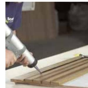
geometría difiera de los valores mencionados. Para obtener una buena y duradera adhesión de Simson MSR Deck Caulk Advanced, es necesario un pretratamiento adecuado de las juntas y ranuras de teca.
