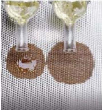
Epiglass tiene menos viscosidad que cualquier otra resina del mercado. Esto proporciona una mejor penetración y protege del drenaje en materiales de fibra de vidrio. Un círculo más grande de Epiglass (en la derecha) muestra qué fácilmente penetra en 510g de tejido.
