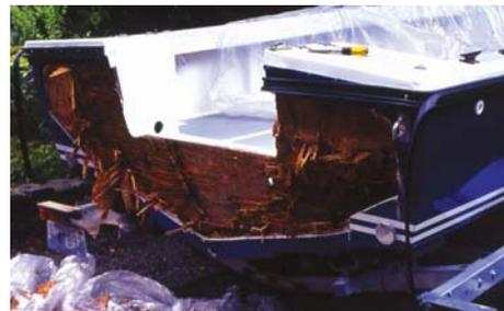
Se deberá lijar el reborde de manera que adopte una forma afilada en cuña y permita formar nuevas laminaciones cuando el espejo sea sustituido. El laminado del espejo extraído necesitará también tener lijado un borde afilado. Lijarlo es un trabajo sucio pero proporcionará mucha resistencia a la nueva junta de fibra de vidrio.
