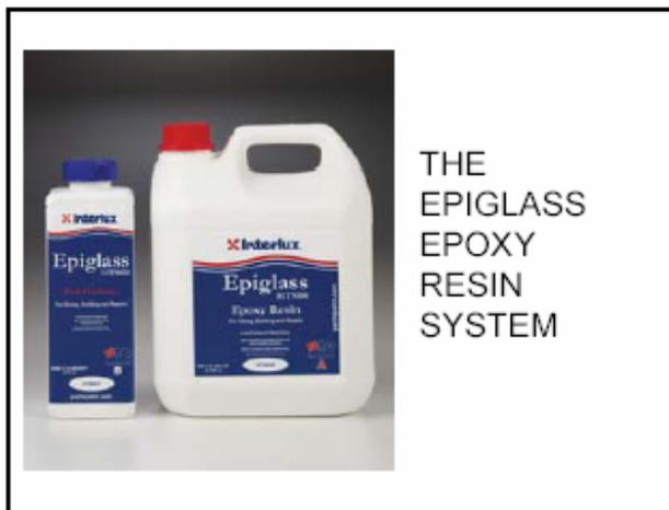
La resina Epiglass Epoxy es un material basado en la polimerización. Está compuesto de dos partes; parte A (la resina) y parte B (el endurecedor). El endurecedor se debe mezclar con la resina para producir un curado en la proporción de 4:1 (por volumen). Existen algunos epoxis que requieren solo una parte, pero Epiglass requiere la suma del endurecedor antes de poderse usar. Epiglass tiene un suave color pajizo ligeramente satinado. Cuando el endurecedor y la resina se mezclan da lugar a una
