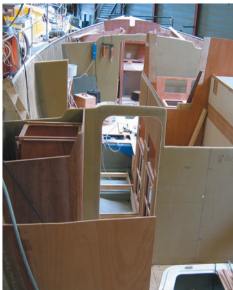
Paneles ligeros pegados en un casco abierto
