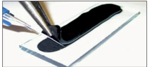
Una vez curado el adhesivo cortar un centímetro o dos del mismo con una cuchilla
