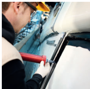
Aplicación del adhesivo en el marco de la ventana
