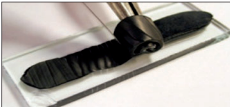
Se tira del cordón en vertical hasta que el adhesivo rompa o despegue. Se continúa hasta el final del adhesivo
