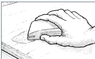
Figura 23 Lije el material de enmasillado curado para darle la forma deseada.
